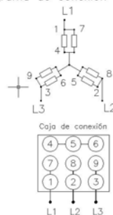
FIG. 12 CONEXIÓN PARA MOTORES 1LA3 (Desde Arm. 143T al 256T=)
